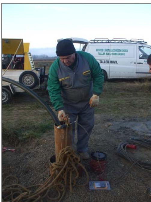
**Imagen 1.** Medición del nivel dinámico del agua durante el aforo.
