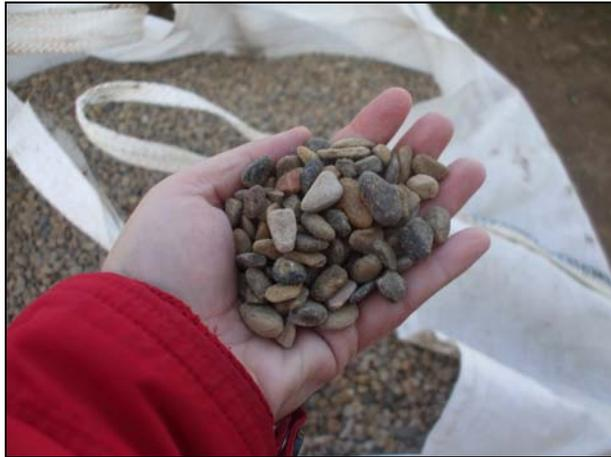
**Imagen 7.** Grava utilizada en el sondeo.
