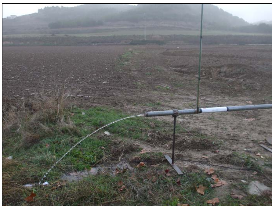
Imagen 4. Caudal extraído durante el cuarto escalón (escalón de larga duración).
