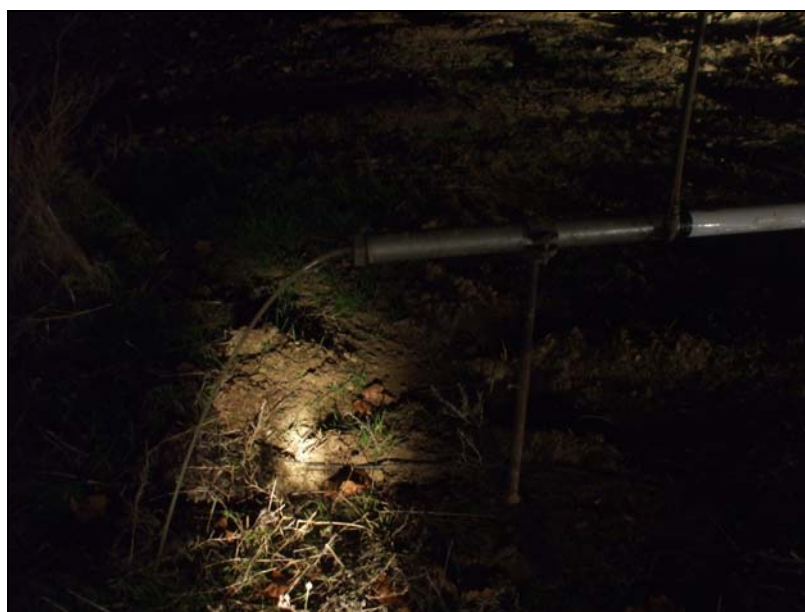
Imagen 2. Caudal extraído durante el primer escalón.
