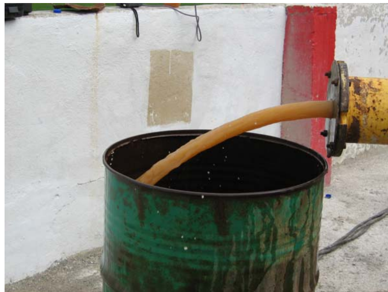
Tercer escalón (agua turbia, 3 l/s)
