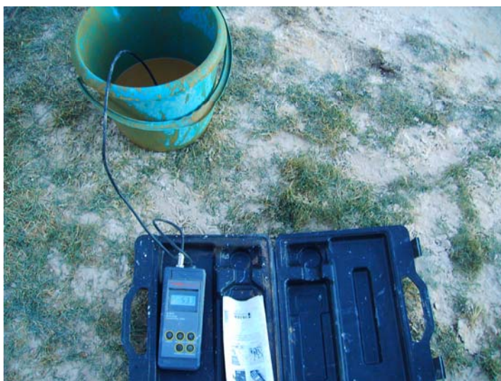
Tomando la conductividad del agua del sondeo
