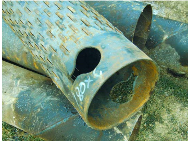
Detalle orejetas abiertas de la tubería de filtro
