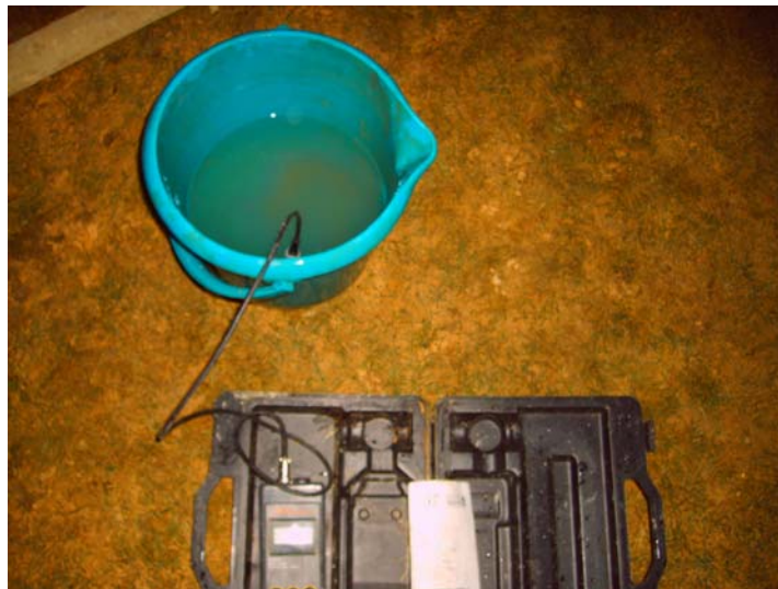
Medida de conductividad de la muestra final de agua
