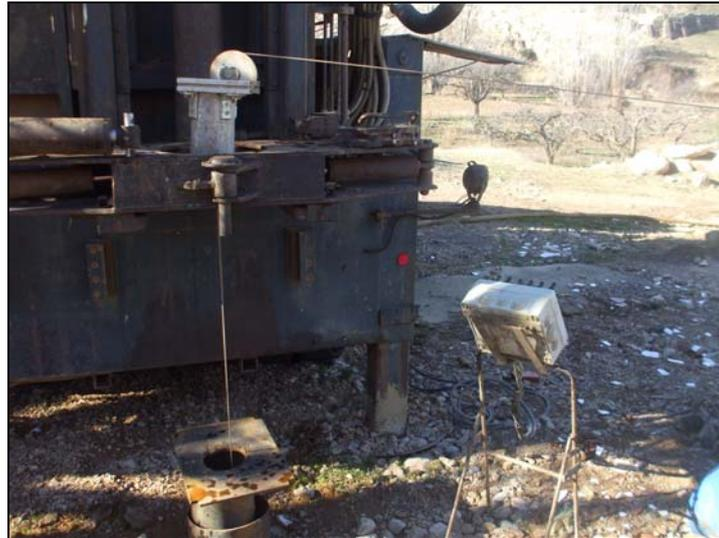
*Imagen 8. Realización de testificación geofísica.*
