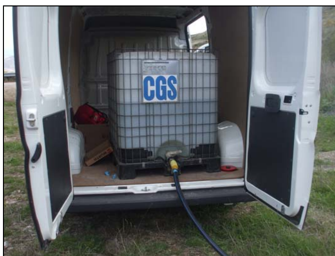
Imagen 1. Depósito utilizado para el ensayo de inyección.
