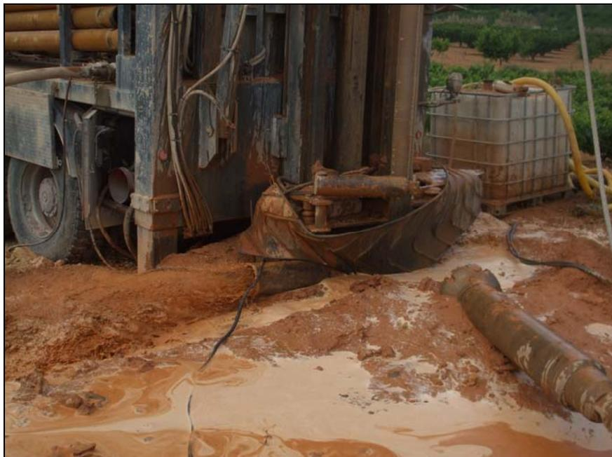
**Imagen 7.** Expulsión de detritus por la pipa durante la perforación.
