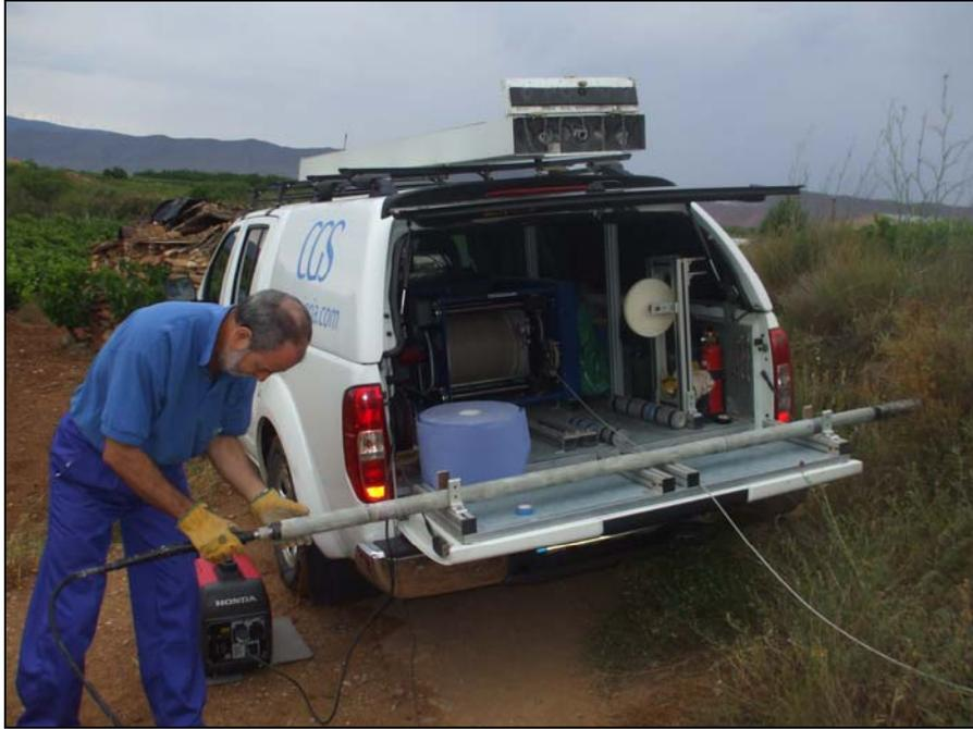
**Imagen 10.** Preparación de la sonda hidrogeológica.
