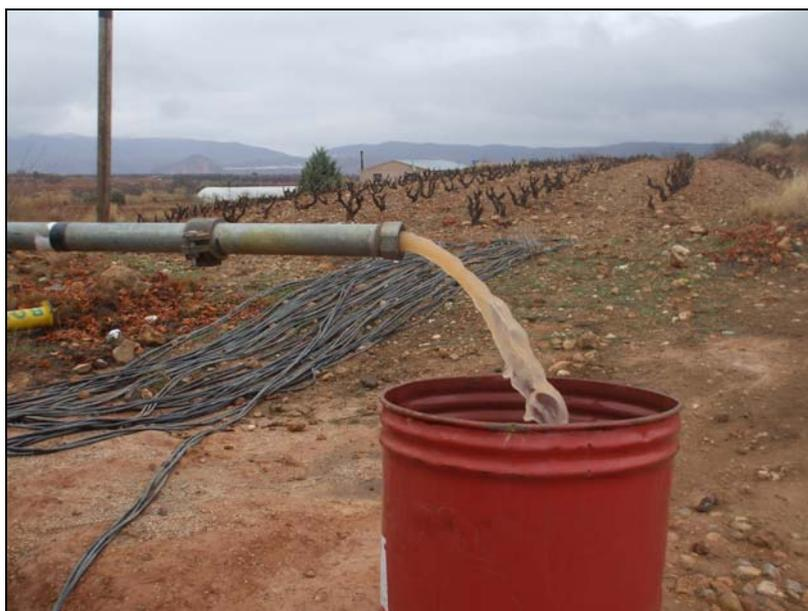
**Imagen 5.** Caudal extraído durante el tercer escalón (escalón de larga duración).
