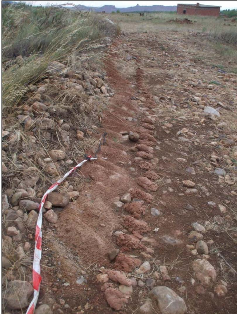
**Imagen 9.** Detalle de las muestras extraídas en la realización del sondeo de Quel.
