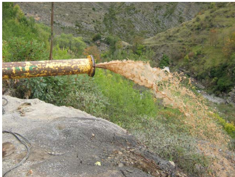
Comienzo cuarto escalón (agua muy turbia, 5 l/s)
