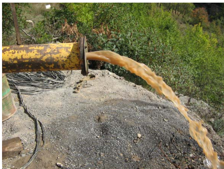
Tercer escalón (agua muy turbia, 3 l/s)
