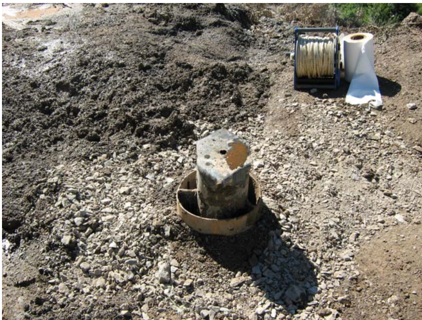
Sondeo tapado provisionalmente con chapa metálica
