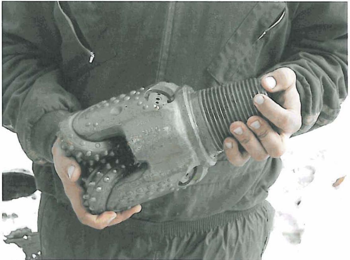
Tricono similar al usado para la perforación.
