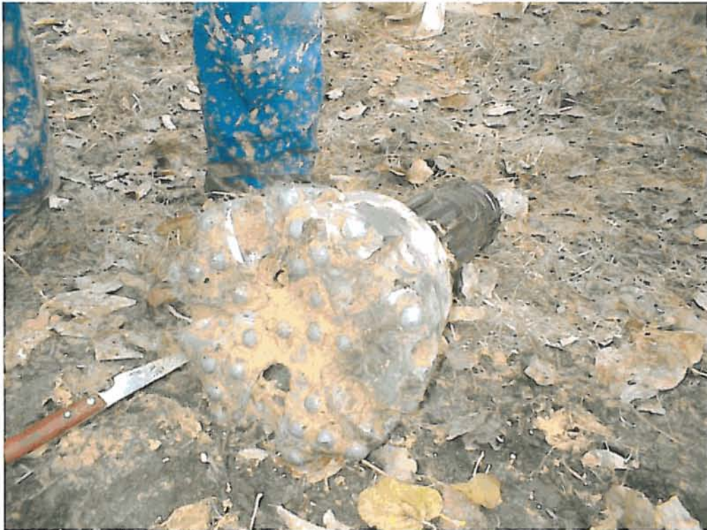
Detalle del tallente del martillo deteriorado.
