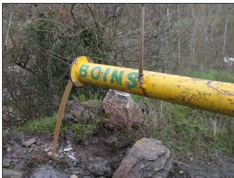
Imagen 4. Caudal extraído durante el primer escalón.
