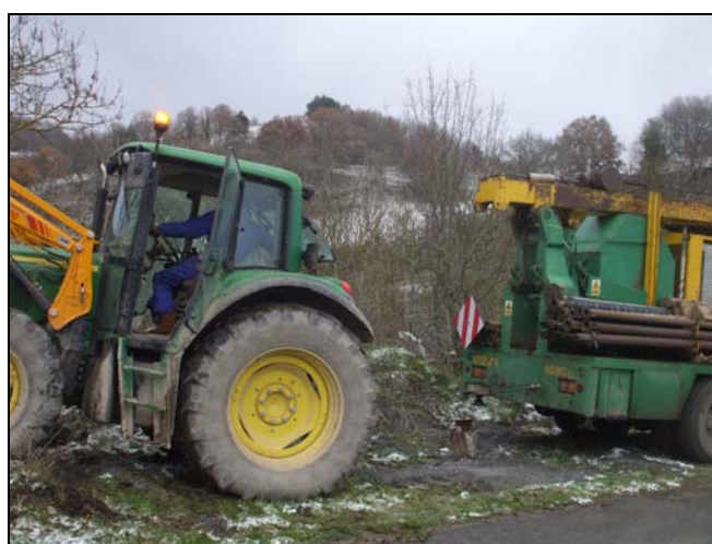
Imagen 1. Colocación del camión de aforos con ayuda de un tractor.
