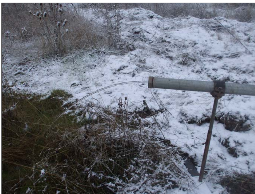
Imagen 5. Caudal extraído durante el segundo escalón (escalón de larga duración).
