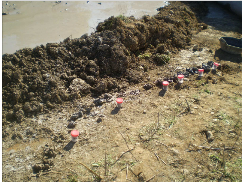
Imagen 5. Muestras obtenidas durante la perforación del sondeo de Briviesca.
