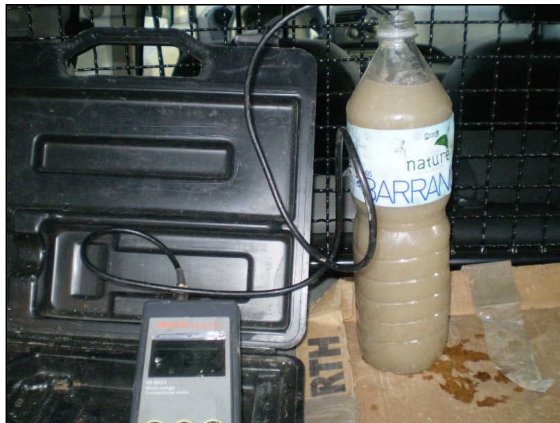
Imagen 8. Medida de la conductividad in situ.
