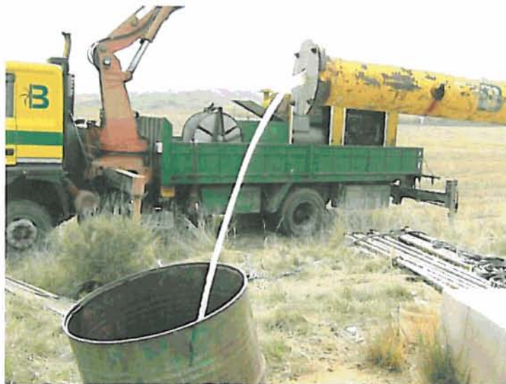
Momentos finales del ensayo, octavo escalón (1 l/s, agua turbia blanquecina)
