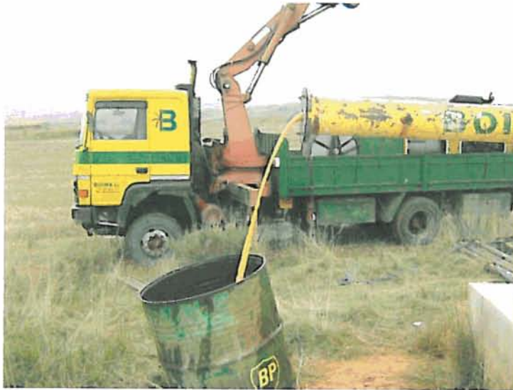
Séptimo escalón agua muy turbia (0,7 l/s)
