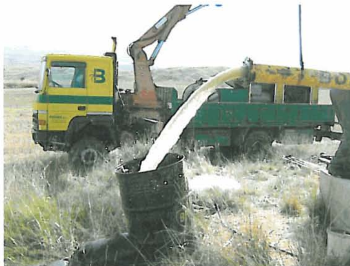
Primer escalón (agua algo turbia, 15 l/s)
