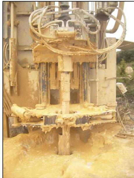
Durante la misma, no se observa apenas que el agua salga por la boca del sondeo, por lo que se piensa que existe una zona muy fracturada por la que se escapa el agua y el aire introducido al sondeo, ya que a la superficie llega muy poca cantidad de aire, agua y vapor. A las 16:45 horas finaliza la limpieza.
