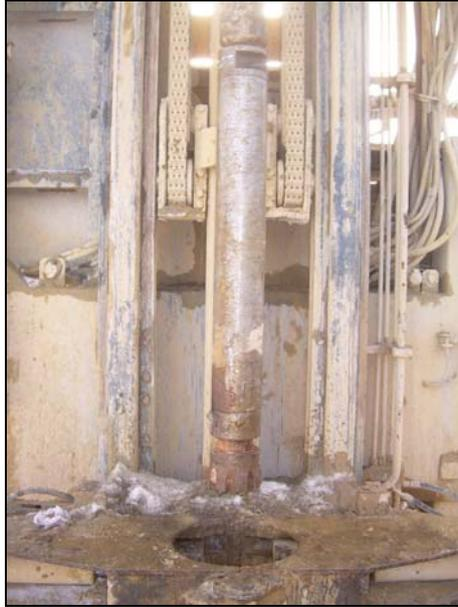
A las 12:00 h comienza la limpieza del sondeo, al comienzo de la misma se no obtienen agua por la boca del sondeo, tan solo vapor de agua, se inyecta agua y espumante. Tras varios minutos el agua y el espumante inyectados dejan de salir dejando paso a una pequeña cantidad de aire, por lo que se entiende que se pierde todo por las fracturas.
