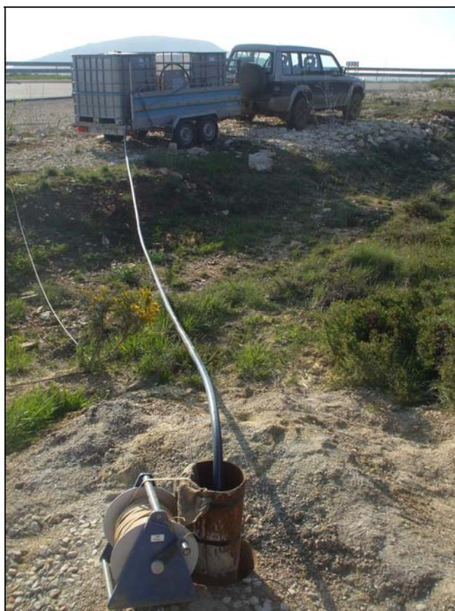
**Imagen 2.** Realización de ensayo de inyección.
