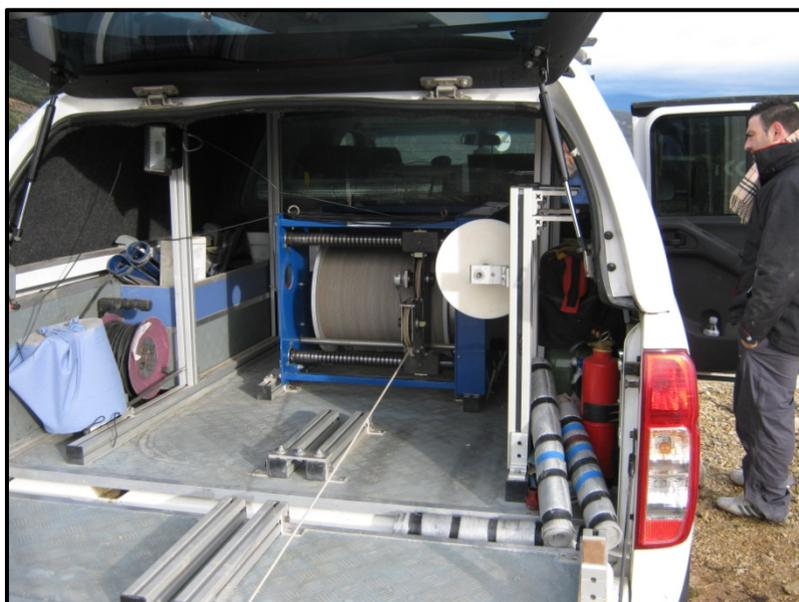
Se procede a introducir la sonda hidrogeológica obteniéndose, sólo el registro de la radiación gamma natural ya que a los 199 la sonda no continúa bajando debido a que a esa profundidad el pozo se ha cerrado. Como consecuencia no se ha podido detectar la presencia del nivel de agua cortado en el metro 198.
