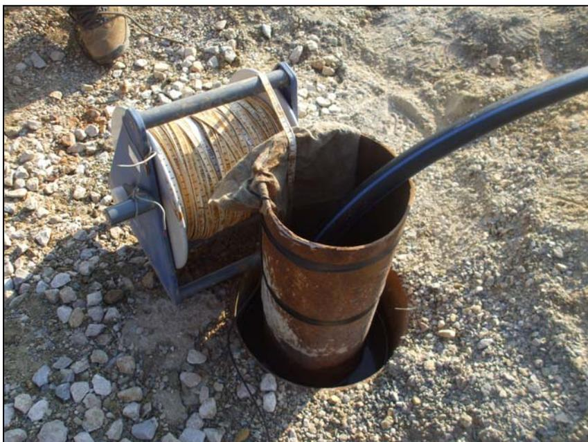
**Imagen 3.** Control de nivel freático mediante sonda hidronivel manual.
