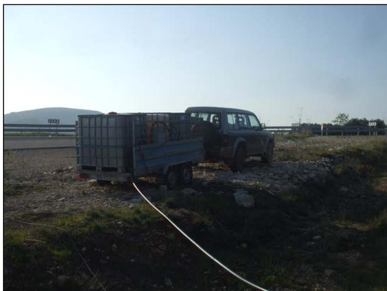
*Imagen 1. Sistema de cubas de agua para ensayo de inyección.*
