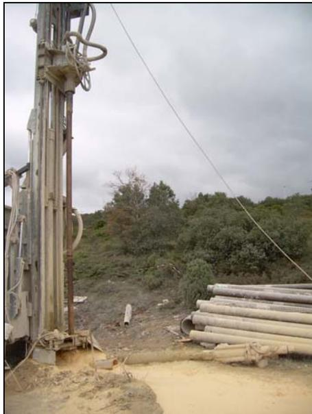
Durante la perforación los materiales atravesados se han compuesto básicamente de calizas y margocalizas.
