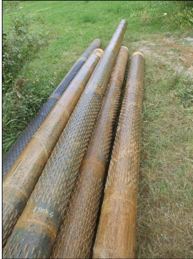
Imagen 8. Aspecto de la tubería extraída del sondeo.
