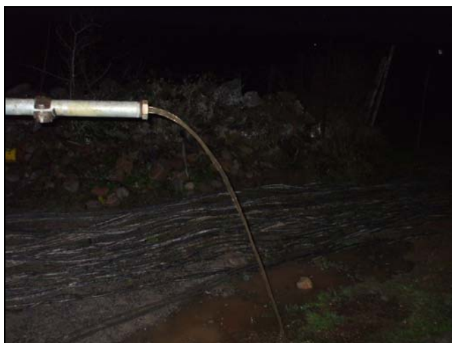
Imagen 3. Caudal extraído durante el primer escalón.
