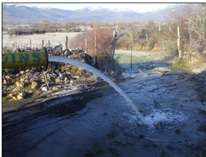
Imagen 7. Caudal extraído durante el sexto escalón (escalón de larga duración).
