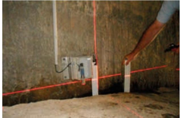
Ajuste de aforador para el cálculo de filtraciones mediante láser, calibrando la escala manual en el vértice del vertedero.
