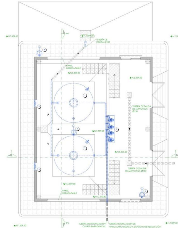
Para la situación de diseño de este proyecto (300 l/s), se han determinado unas necesidades máximas de este reactivo de 91,38 l/h y 33,23 en condiciones medias, proyectándose bombas de dosificadoras peristálticas con variación de frecuencia:
