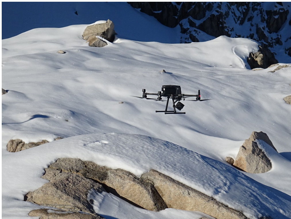
Dron Matrice 300 RTK con cámara lidar y fotogramétrica
