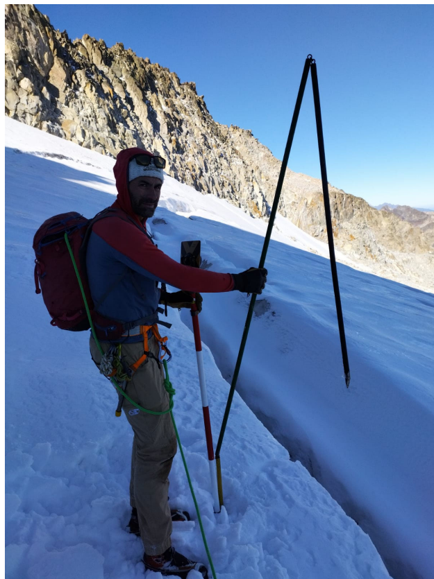
Baliza 27, cota 3.142 m. Pérdida de 305 cm de espesor de hielo. Desplazamiento horizontal de 2,10 m.
