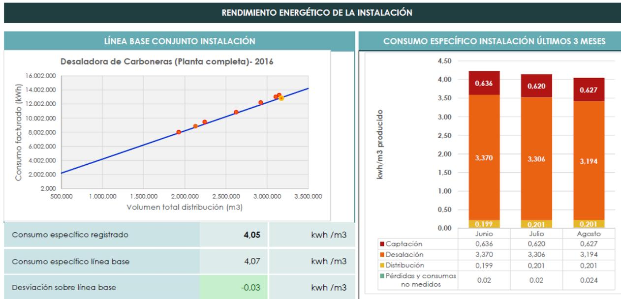
*Desaladora de Carboneras: Mejora en el rendimiento detectada tras la puesta en servicio de nuevos recuperadores de energía en 1 bastidor*
