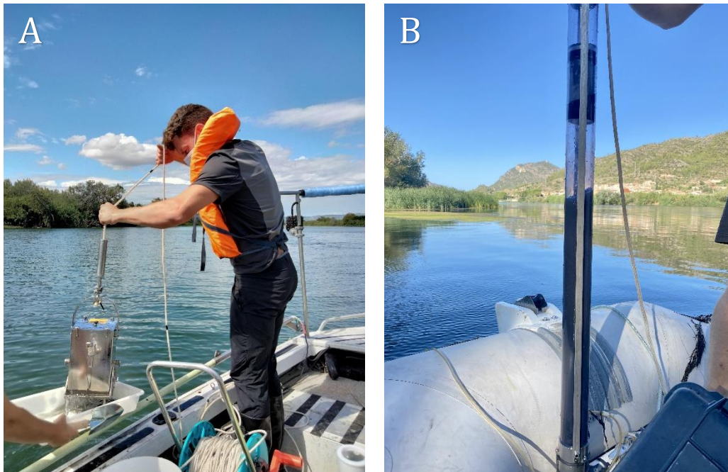
Figura 10.- Técnicas de muestreo para la extracción de sedimentos con un tamaño de partícula inferior a 2 mm. Draga tipo Ekman (A) y Piston Coring (B).
